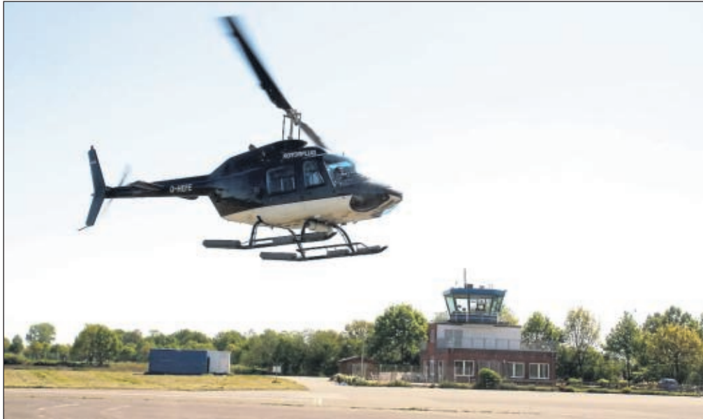
Die Bell 206 Jet Ranger erreicht mit ihren 420 PS eine Geschwindigkeit von knapp über 200 Kilometern in der Stunde. Sie ist knapp 1,5 Tonnen schwer und die Flugzeit wird mit etwa dreieinhalb Stunden kalkuliert. ■ Fotos: Reckmann
